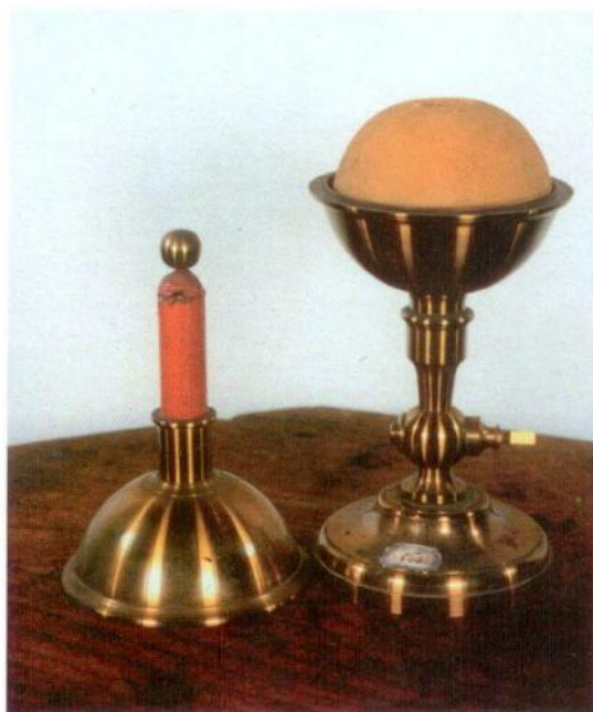
Fig. 1. Apparato di Faraday per lo studio dei dielettrici; non firmato, costruito in ottone e cera, 2ª metà secolo XIX.
