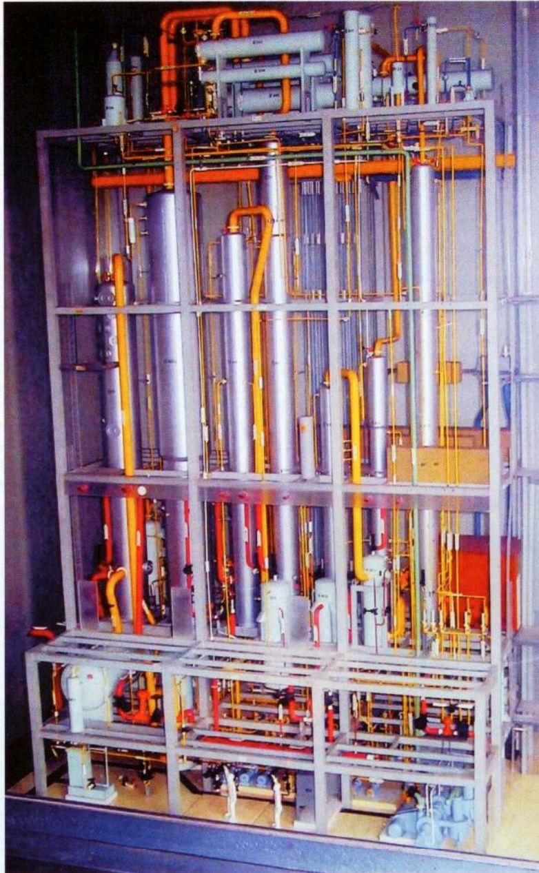
Fig. 9. Modello di un impianto di distillazione per ottenere alcool etilico da brodi di fermentazione del melasso. E' stato costruito negli anni '60 dalle DISTILLERIE REGGIANE spa e donato alla "Scuola di specializzazione in Tecnologia per la produzione dello zucchero e dell'alcool" dell'Università di Ferrara. Il modello, riporta tutti i particolari delle varie colonne di distillazione presenti in un impianto industriale (in scala 1:20).
