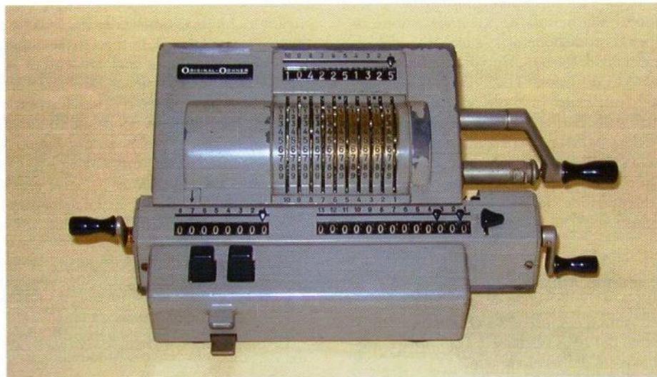
Fig. 7. Calcolatrice meccanica Original Odhner (Svezia), acquistata nel 1964; inventariata 89806CNR. Struttura in metallo verniciato grigio con levette, pulsanti e manovelle; pur mancando le istruzioni per l'uso sembra ancora funzionante.
