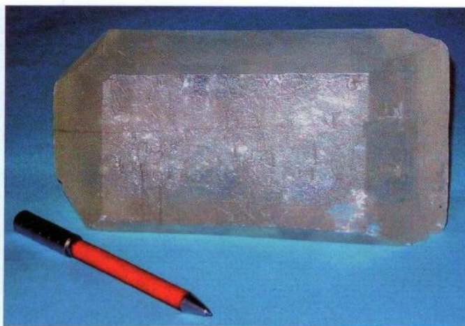
Fig. 9. Cristallo di saccarosio; è il più grande monocristallo di saccarosio presente nel mondo e pesa circa 2 kg. È stato ottenuto con un lungo e paziente lavoro (circa 2 anni) dal prof. Giorgio Mantovani negli anni '50 presso i laboratori della Scuola di specializzazione in «Tecnologia per la produzione dello zucchero e dell'alcool» dell'Università di Ferrara.
