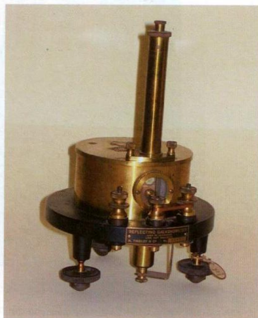
Fig. 11. Galvanometro, Reflecting Galvanometer della Tinsley & Co. London n. 22497 (Inghilterra). Struttura in ottone in scatola di legno originale; da un cartellino risulta essere stato proprietà del prof. Cavallaro. Strumento per la misura di correnti elettriche di piccola intensità.
